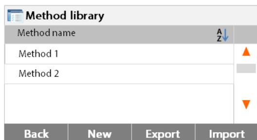
Die Methodenbibliothek enthält bis zu 100 Methoden. Alle Methoden, die zuvor eingegeben wurden, können abgerufen werden und die Parameter für die abgerufene Methode werden wenn ausgewählt wiederholt.
