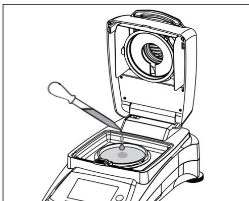
Öffnen Sie die Abdeckung des Feuchtigkeitsmessgeräts. Befeuchten Sie die Glaswasserschale mit 0,5 bis 1 Gramm Wasser.
