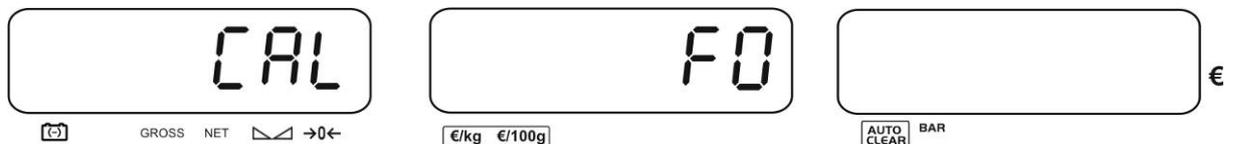
4. Die erste Funktion „F0 CAL“ wird angezeigt. **Justierschalter drücken.**
