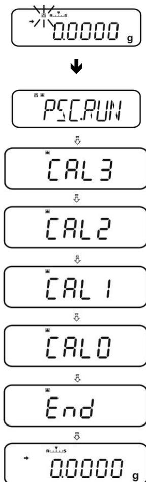
Sobald die Grammanzeige nach Abschluss der Justierung mittels PSC wieder erscheint, befindet sich die Waage wieder im Wägemodus.
