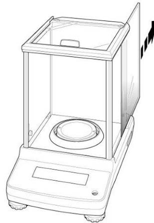
Abb. 2: Glastüren entfernen
