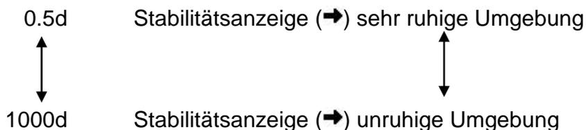
⇒ Mit **TARE** bestätigen. Die aktuelle Einstellung wird durch die Stabilitätsanzeige (→) gekennzeichnet.
