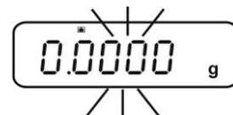
⇒ Justiergewicht abnehmen und Windschutztüren schließen. Nach erfolgreicher Justierung kehrt die Waage automatisch in den Wägemodus zurück.
