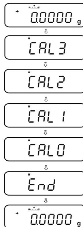
⇒ Nach erfolgreicher Justierung kehrt die Waage automatisch in den Wägemodus zurück.
