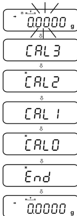
Sobald die Grammanzeige nach Abschluss der Justierung mittels PSC wieder erscheint, befindet sich die Waage wieder im Wagemodus.
