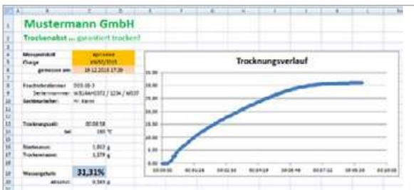
Messprotokoll mit Verlaufdiagramm einer Feuchtebestimmung
